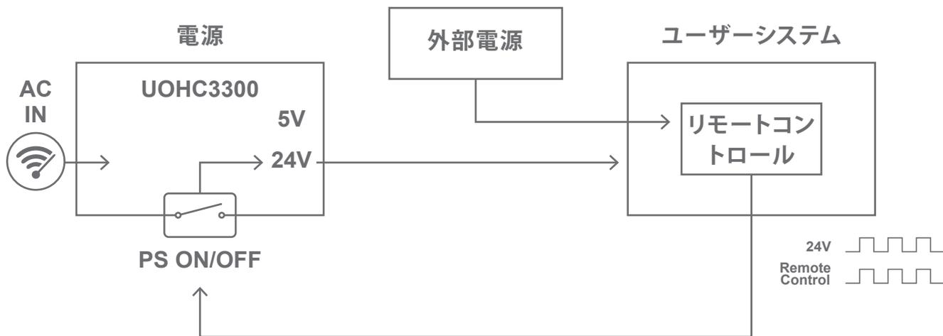
リモートコントロールON/OFF回路使用例
